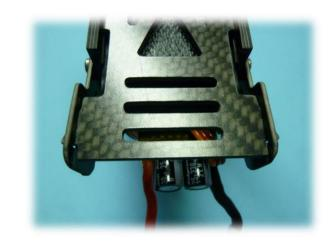
Die Halteplatten so lange Verschieben, dass die Laschen beim Einschieben der Akkuplatte, ohne äußeren Kraftaufwand einrasten. Danach die 4 Stück M2,5x12 Zylinderkopf Inbusschrauben festziehen.
