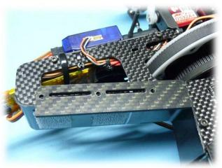
Auf die Führungsplatten dann die Halteplatten positionieren und mit den mitgelieferten Schrauben vorerst nur leicht anziehen.
